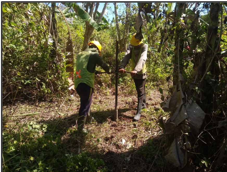
Photo 3 : Penelitian boring untuk mengetahui lapisan tanah / UDS / SPT tes (BH-1)
