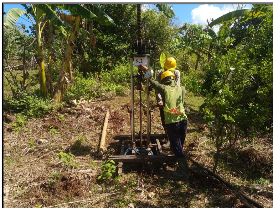
Photo 2 : Penelitian Sondir untuk menentukan daya dukung tanah ijin (S-2)
