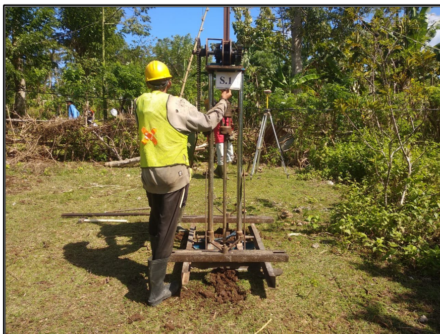
Photo 1 : Penelitian Sondir untuk menentukan daya dukung tanah ijin (S-1)
